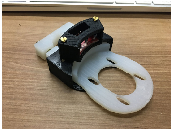
Figura 4.5: Suporte dos sensores Hall posicionados no suporte do motor de protótipo
