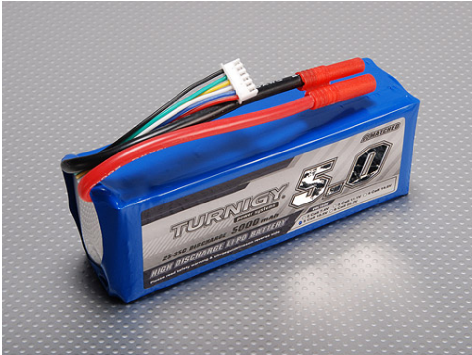
Figura 2.52: Bateria Lipo 5Ah 5S. Podemos ver os fios positivo e negativo (vermelho e preto) e fios coloridos que permitem o acesso a cada célula individualmente da bateria (Fonte: [52]).
