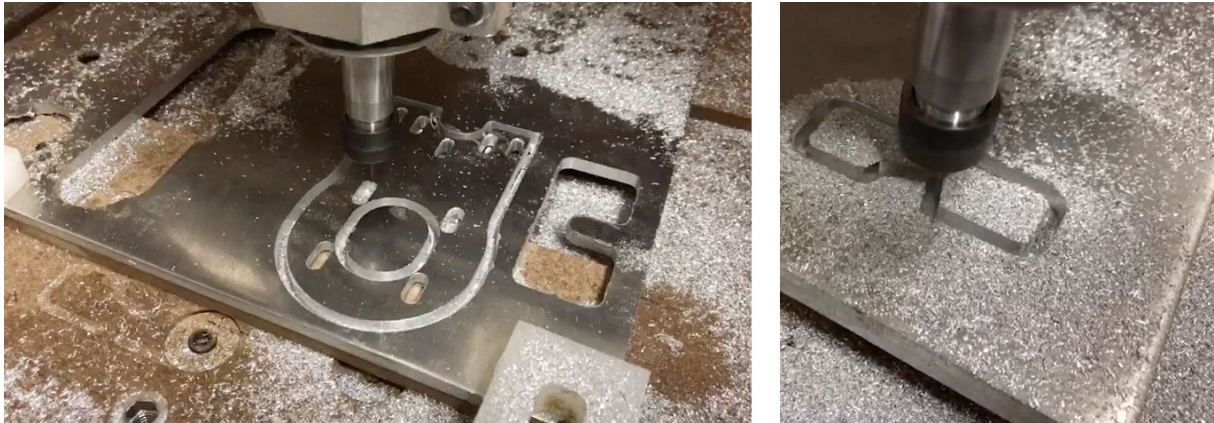
Figura 4.1: Suporte do motor sendo cortado em uma CNC usando o alumínio como material
