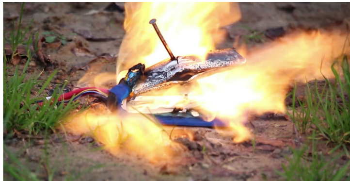
Figura 2.49: Bateria Lipo sendo perfurada. Imagem do vídeo https://www.youtube.com/watch?v=gisdMQbtJqk (Fonte: [48]).
