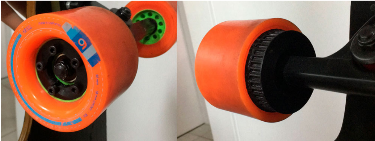
Figura 4.3: Polia da roda impressa em 3D no material PLA
