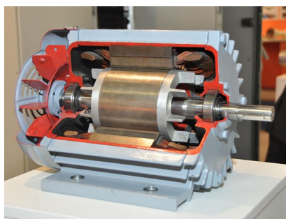
Figura 2.12: Corte de um motor por indução (Fonte: [20]).
