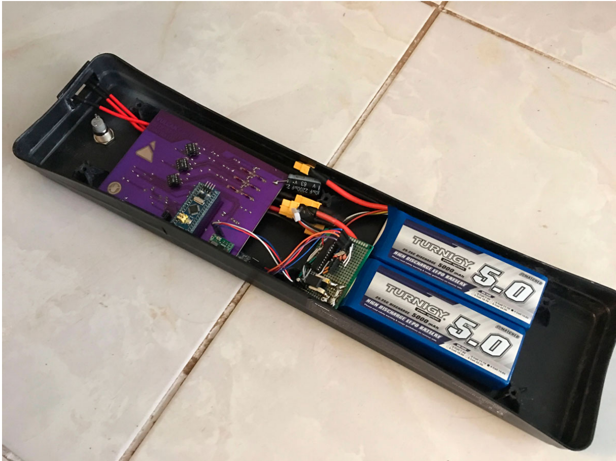
Figura 4.9: Placa do controlador sem sensor dentro do encapsulamento com as baterias
